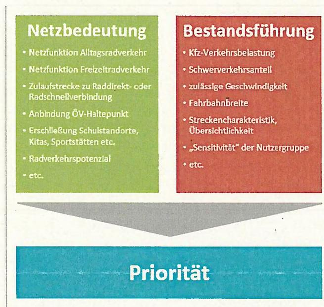
Abbildung 1: Wesentliche Eingangsparameter bei der Dringlichkeitsbewertung von Radverkehrsanlagen
