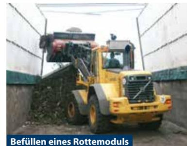
Befüllen eines Rottemoduls
