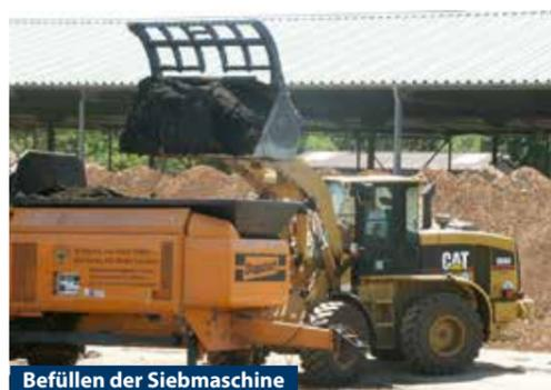
Befüllen der Siebmaschine
